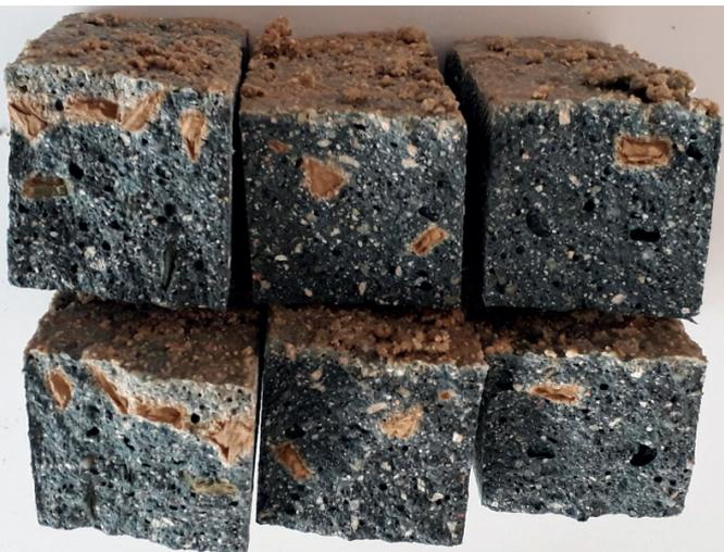
Figure 1 Éprouvettes 4x4x16cm de MMA avec substitution par un sol argileux après rupture en flexion.
