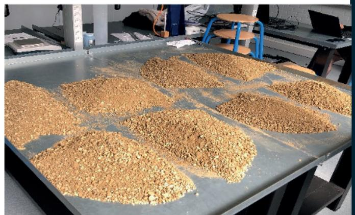
Figure 1 : Granulats recyclés issus de la démolition d'une ancienne école
