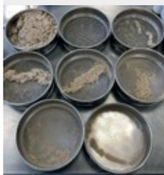
Figure 1 : Analyse granulométrique des fibres d'acétate de cellulose
