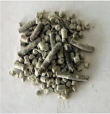
Figure 1 : Polyuréthane en granulés (PUG)
