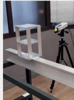
*Figure 3 : Vibromètre laser*
