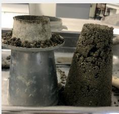
Figure 2 : Affaissement avant l'ajout de superplastifiant
