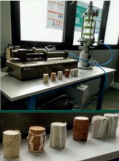
Figure 1 : Appareil triaxial avec ses contrôleurs et des éprouvettes de sols sollicités jusqu'à la rupture
