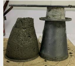
Figure 3 : Affaissement après l'ajout de superplastifiant
