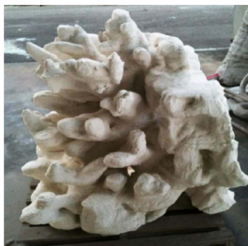
Exemple de récif artificiel imprimé en 3D par une équipe de recherche Australienne (Mohammed, 2016)
